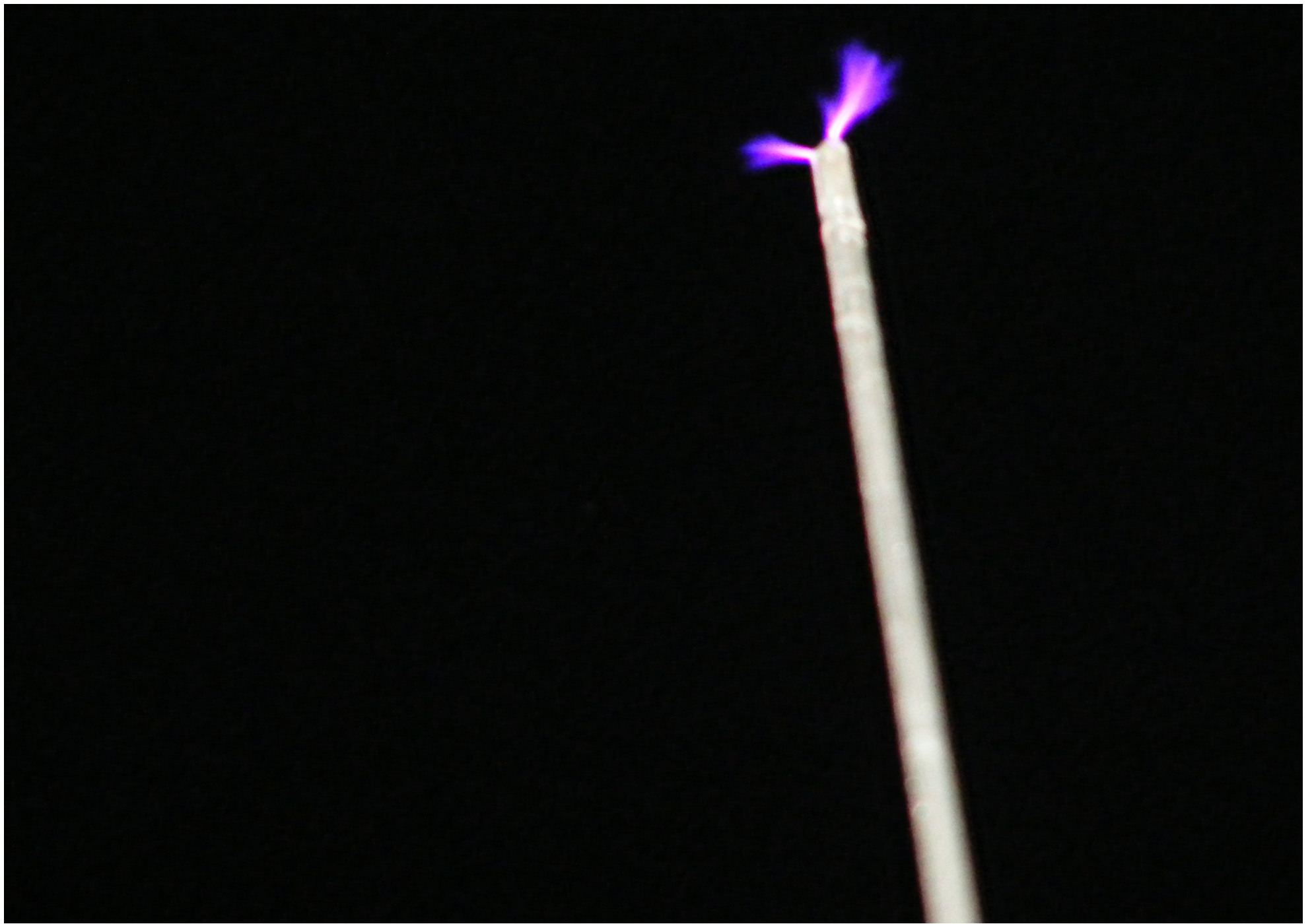
Korona kisülés a még hegyes végű mobilantennán.
