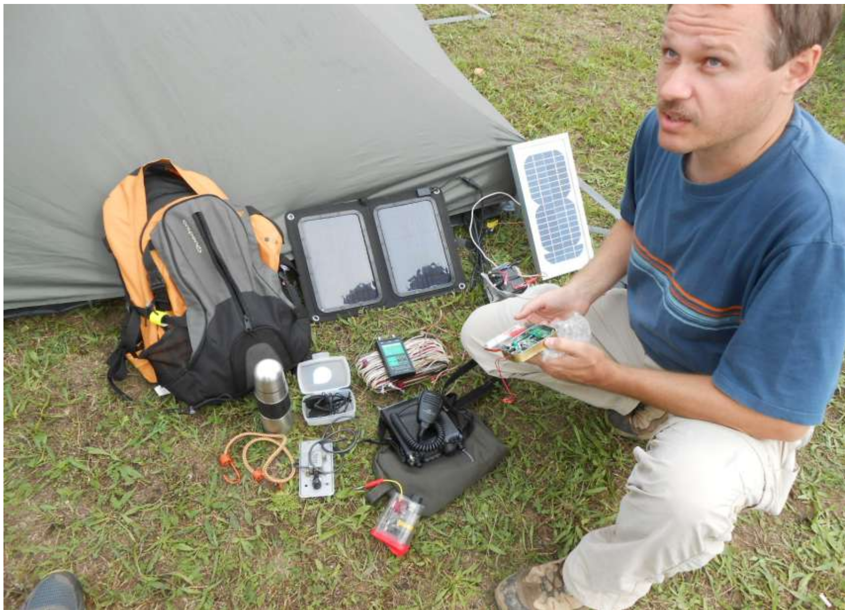
HA5CQZ Zoli SOTA felszerelése: FT-817, antennák, napelemek
