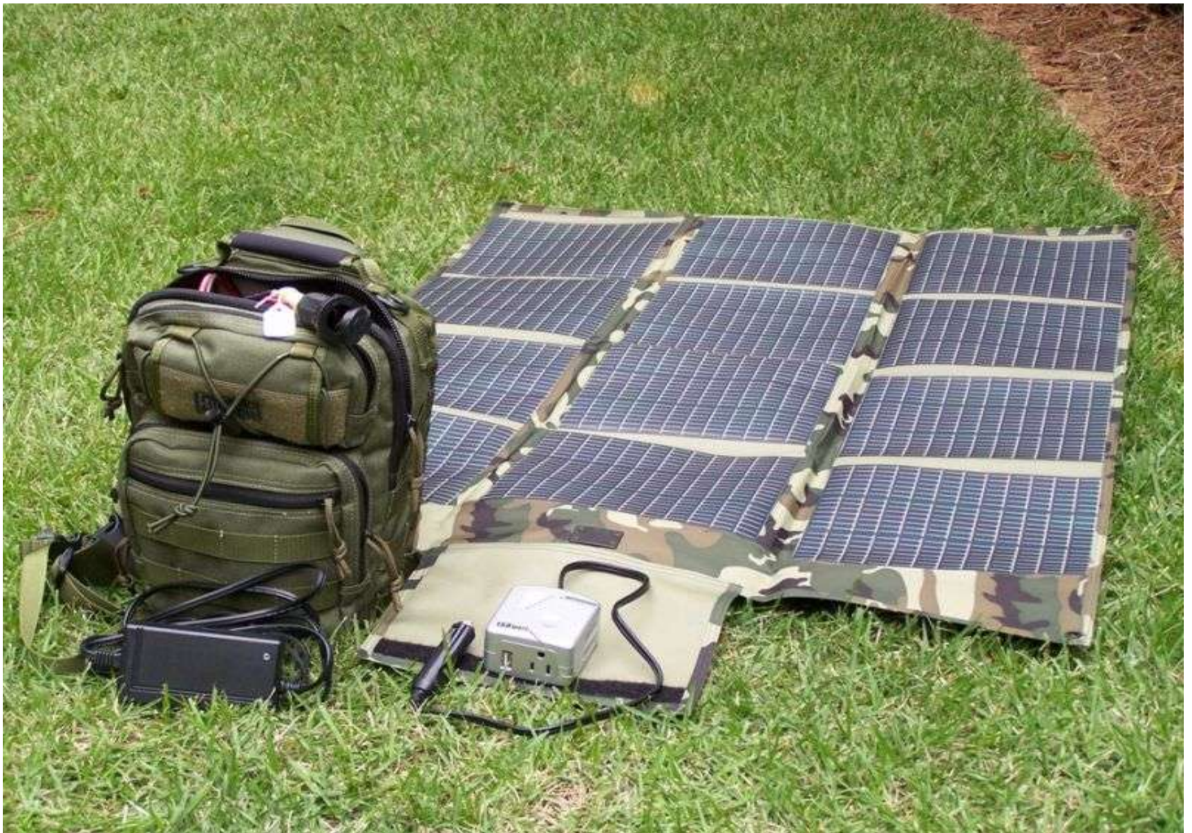
SOTA-hoz PowerFilm energia hátizsák LiPo akkuval, inverterrel, 180 W flexi napelemmel
